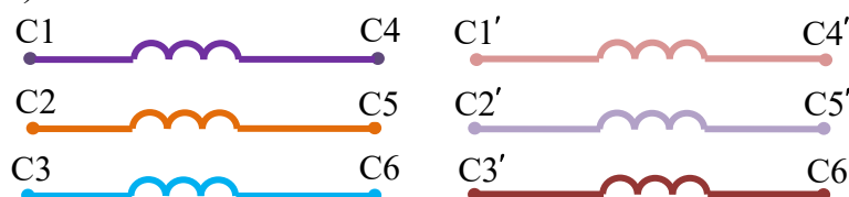
Рисунок 4 – Общий вид в соответствии со стандартом NEMA обмоток статора 3-х фазного двигателя с двенадцатью выводами
