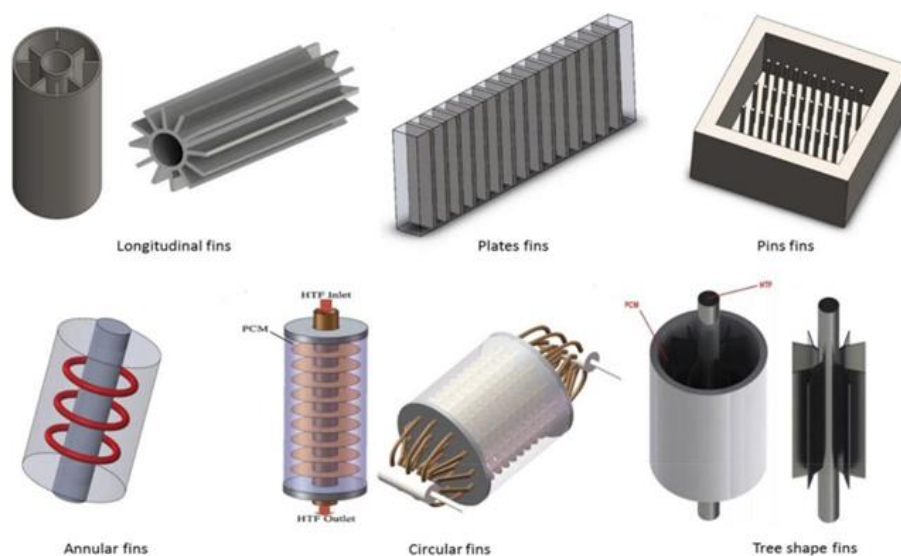
Рисунок 2 – Различные формы тепловых аккумуляторов с использованием теплоаккумулирующих материалов [8].
