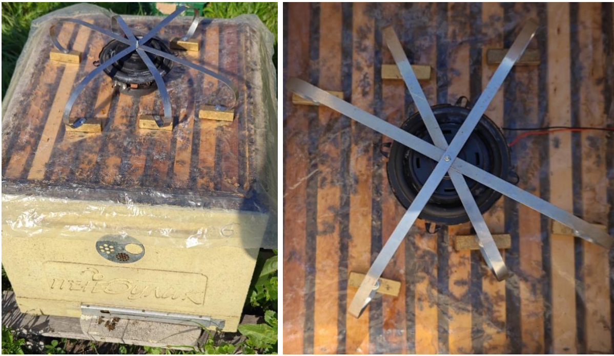
Рисунок 3 – Фотографии разработанной вибрационной установки от клеща Варроа
